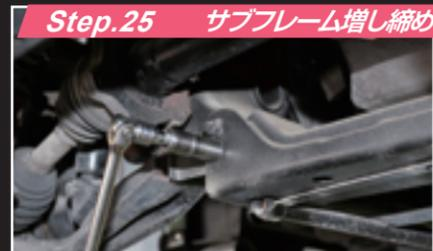
**Step.25 サブフレーム増し締め**
